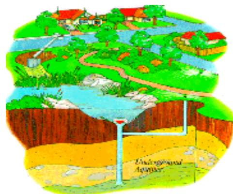
Σχήμα 3-3. Λίμνες κατακράτησης- Εμπλουτισμός υπόγειων νερών (ΣΑΛΑ)
