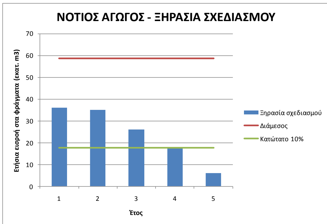
Σχήμα 4-2: Σύγκριση Αθροιστικής Κατανομής Ιστορικού και Συνθετικών Δειγμάτων Ετήσιοι όγκοι εισροής στα φράγματα για την πενταετή περίοδο ξηρασίας σχεδιασμού.
