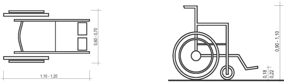
Σχήμα 3- Βασικές διαστάσεις χειροκίνητου αναπηρικού τροχοκάθισματος.
