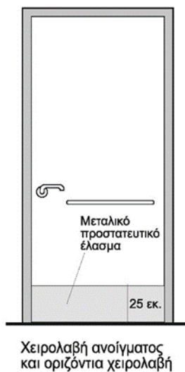
Σχήμα 76- Θύρα χώρου υγιεινής με χειρολαβή εσωτερικά, για τράβηγμα της θύρας
